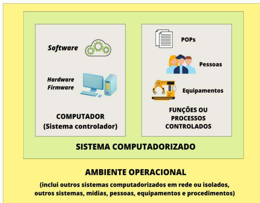
Figura 2 - Representação esquemática de um Sistema Computadorizado
